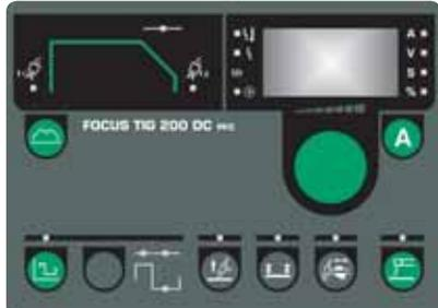
Панель сварки TIG DC (постоянным током) предназначена для сварки любых материалов кроме алюминия и алюминиевых сплавов. Панель также управляет сваркой MMA с использованием большинства существующих типов электродов. Функции кнопок описаны на обороте.
