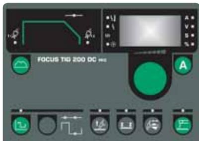
TIG DC řídicí panel pro svařování všech kovů mimo hliník a jeho slitin. Umožňuje též svařování obalenou elektrodou (MMA). Funkce jsou popsány na druhé straně tohoto průvoce.
