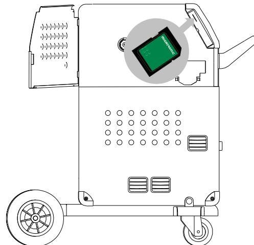
**Alle machine gebruikers-instellingen worden gewist wanneer het programma 10645900.bin wordt ingevoerd. Verwijder daarom, na de software update, altijd de SD kaart uit de machine. Hierdoor wordt, continue software update voorkomen iedere keer dat de machine aangezet wordt.**
