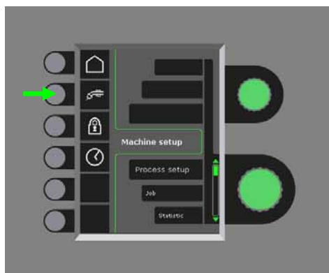
Obracaj niższą z gałek sterowania, aż do wyświetlenia pożądanej konfiguracji. Naciśnij gałkę ✓ aby potwierdzić wybór (wybraną konfigurację wskazuje znak ✓):
