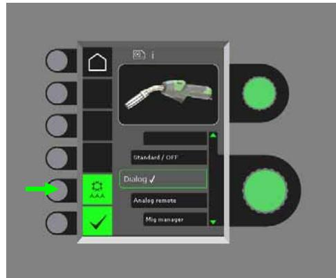
Wanneer een a MIG Manager® toorts is aangesloten, zal de waterkoelfunctie automatisch geactiveerd worden en zal deze uitvoering geannuleerd worden.
