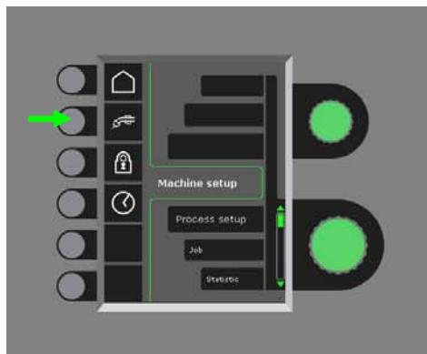
Der untere Drehregler muss gedreht werden, bis die gewünschte Konfiguration gezeigt wird. Zur Bestätigung der Konfiguration muss die ✓-Taste gedrückt werden (Die gewählte Konfiguration ist durch das ✓-Zeichen angezeigt):
