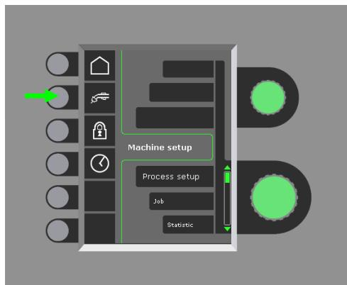
Draai aan de onderste regelknop totdat de gevraagde configuratie wordt weergegeven. Druk op de ✓-knop om de keuze te bevestigen (de gekozen configuratie wordt aangegeven met ✓):
