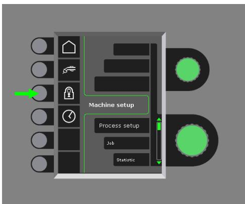
Die gewünschten Funktionen sind durch Einsetzen einer SD Sperr-Karte gesperrt und wieder durch Einsetzen der SD Sperr-Karte entsperrt.
