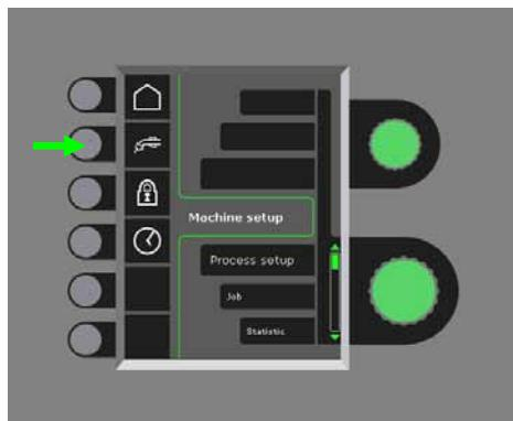
Gire el botón de control más bajo hasta que la configuración requerida es mostrada. Presione la tecla ✓ - para confirmar la selección (la configuración seleccionada es indicada por ✓):
