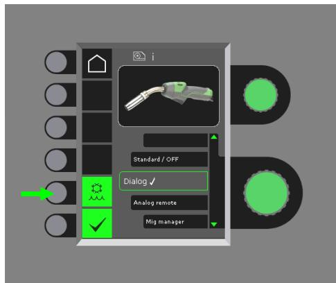
Jeśli podłączony jest MIG Manager®, będzie on sterował automatycznie funkcją chłodzenia wodą i zablokuje tę konfigurację.
