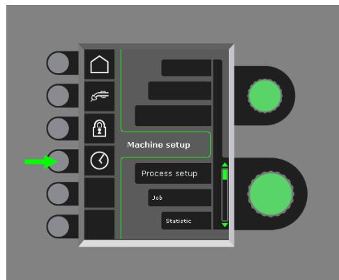
Als het loggen van bijv. fouten moet worden gebruikt, is het belangrijk om de juiste tijd in te stellen. De instelling wordt bevestigd door op het volgende keypad te drukken nadat het instellen is voltooid:
