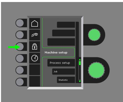
Las funciones serán bloqueadas seleccionando el nivel de bloqueo, insertando la tarjeta SD-Bloqueo y desbloqueando volviendo a insertar la tarjeta de bloqueo.
