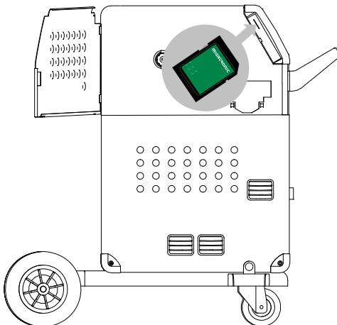
**¡** *Todos los ajustes de usuario de máquina son borrados cuando el archivo 10645900.bin ha sido insertado. Por lo tanto quite siempre la tarjeta SD de la máquina después de la actualización del software. Así evitamos una actualización continua del software cada vez que encendemos la máquina.*
