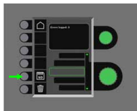
Die Fehlerliste ist dann auf die SD-Karte gespeichert. Die Fehlerliste kann durch Drücken der Taste mit dem Müllheimer nullgesetzt werden.
