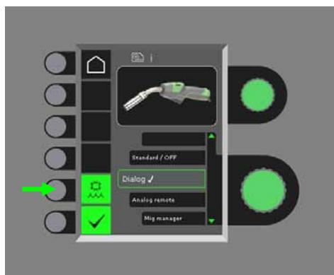
Cuando conectamos una MIG Manager® controlará automáticamente la función de refrigeración e inutilizará esta configuración.
