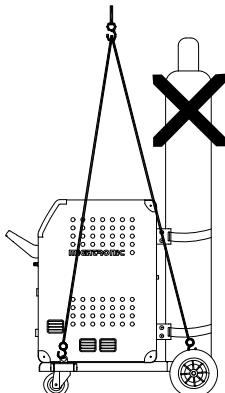
Til de machine niet op met de handgreep.
