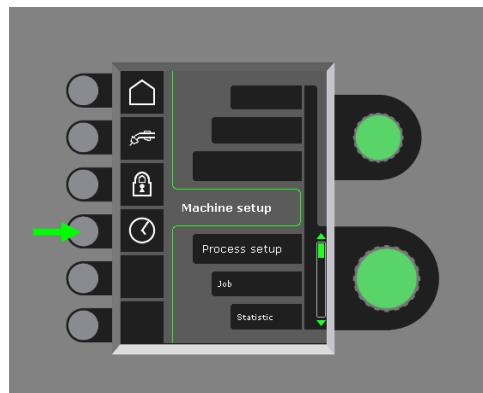
Es ist wichtig die korrekte Zeiteinstellung zu machen wenn z.B. die Fehlerliste angewendet werden soll. Die Einstellung wird durch Drücken der folgenden Taste akzeptiert:
