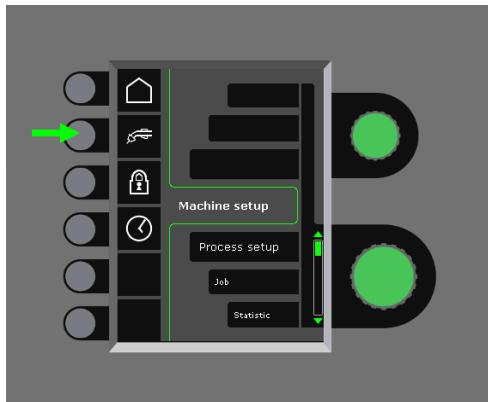
Drej på nederste drejeknap indtil den ønskede konfiguration vises. Tryk på ✓-tasten for at bekræfte valget (valgt konfiguration indikeres ved ✓):
