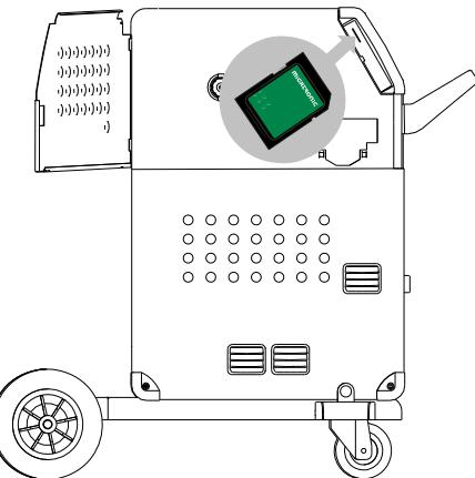
Alle Benutzereinstellungen werden überschrieben wenn die Dateien 10645900.bin eingelesen wird. Die SD-Karte soll deshalb nach Einlesen der Software immer von der Maschine entfernt werden. Damit wird die Software nicht ständig eingelesen, wenn die Maschine eingeschaltet wird.
