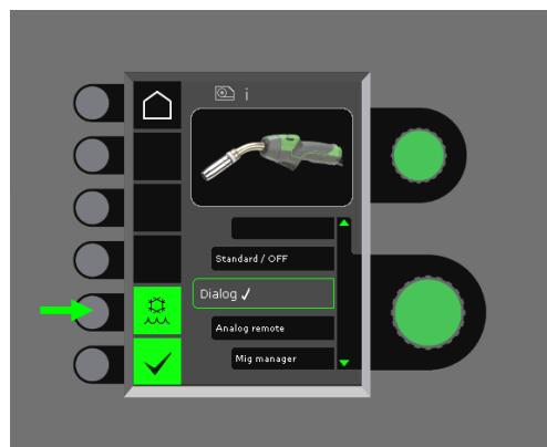
Når MIG Manager® er tilsluttet, kontrollerer den automatisk vandkølefunktionen og sætter denne konfiguration ud af drift.
