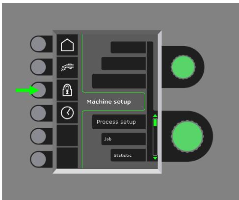
Funktioner låses till den valda låsnivån genom att sätta in SD-låskortet och låses upp genom att återinsätta SD-låskortet.
