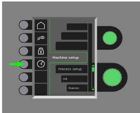
Es importante ajustar la hora correcta, si por ejemplo el registro de errores debe ser utilizado. El ajuste es confirmado presionando el siguiente botón después de que el ajuste sea completado:
