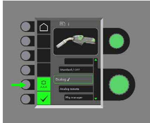
Wenn der MIG Manager® angeschlossen ist, kontrolliert er die automatische Wasserkühlfunktion und setzt diese Konfiguration außer Betrieb.
