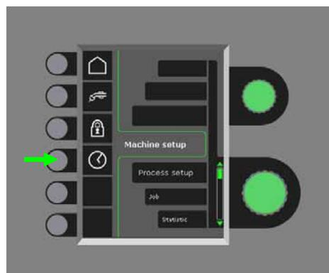
Il est important de régler l'heure exacte, notamment pour l'enregistrement des erreurs. Une fois l'heure définie, appuyer sur la touche suivante pour confirmer le réglage :
