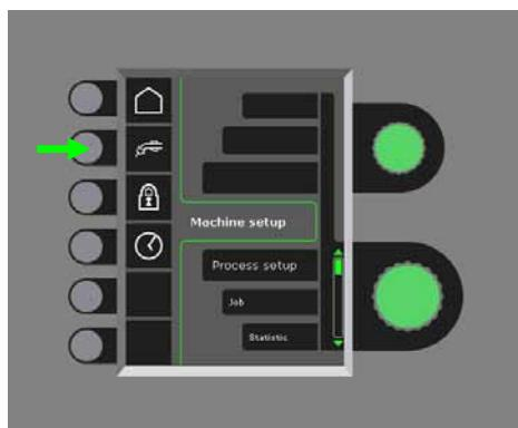
tourner le bouton de réglage inférieur jusqu'à l'affichage de la configuration souhaitée. Appuyer sur la touche ✓ pour confirmer la sélection (la configuration sélectionnée est indiquée par ✓) :
