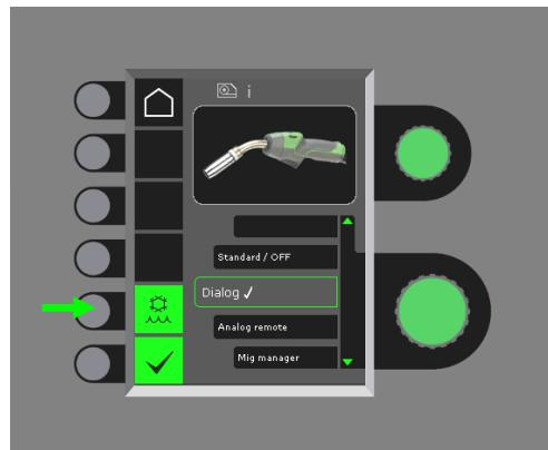
När MIG Manager® är anslutet, kontrollerar den automatisk vattenkylningsfunktionen och sätter denna konfiguration ur drift.
