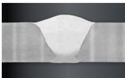
IAC-grondlaag verticaal neergaand gelast in koolstofstaal van 10 mm; gevuld met twee verticaal neergaand gelaste Sequence Repeat-lagen.
