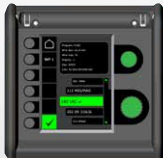
Intelligente boogbesturing IAC™: Automatische voorspelling van de volgende milliseconden van het lasproces.
