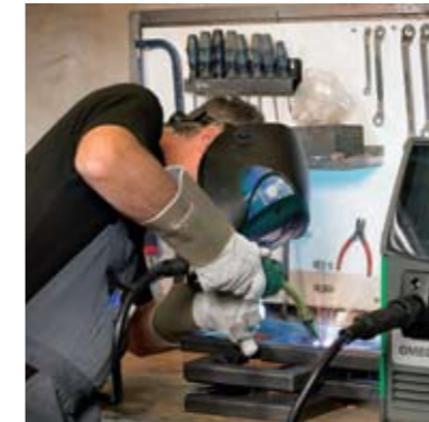
Lassen van profielen van meubelframes in koolstofstaal.
