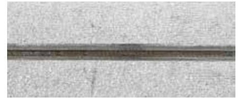
Plasma-keyholelas van 6 mm roestvast staal
