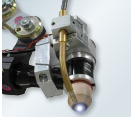
Beschermde wolfram elektroden- langere standtijd
