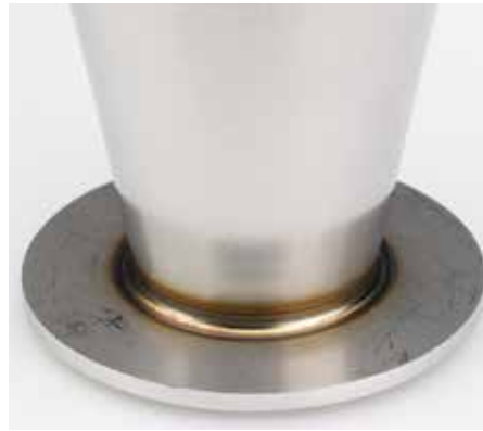
Plasma-keyholelas van 6 mm roestvast staal
